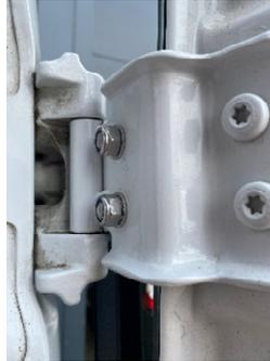
1. Schrauben M8x20 von außen nach innen durch Befestigungswinkel.
