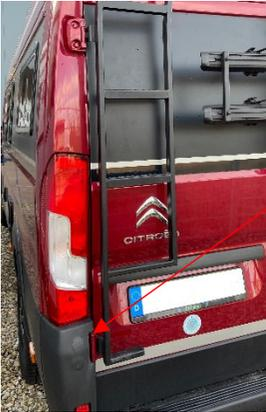
Türstopper links entfernen und die Verschlussstopfen vorsichtig in die verbleibenden Löcher einsetzen.
