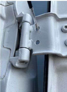
Korrosionsschutz an allen Löchern anbringen
